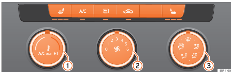
Fig. 90 Pe consola centrală: panoul de comandă a sistemului de climatizare manuală.
