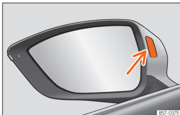
Fig. 127 Lampa de control asistent menținere bandă.
