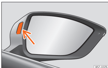
Fig. 128 Lampa de control asistent menținere bandă.
