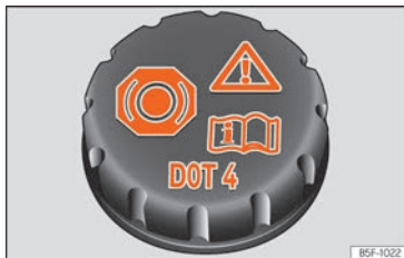
Fig. 174 Compartimentul motor: capacul rezervorului pentru lichidul de frână.
