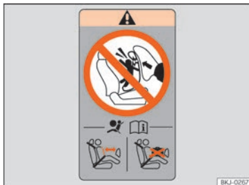
Fig. 34 Autocolant airbag: în partea de jos a cadrului ușii pasagerului.
