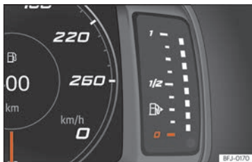
Fig. 4 Panou de bord SEAT Digital Cockpit: indicator rezervă combustibil.
