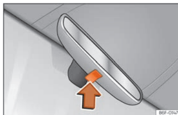
Fig. 77 Funcția de reglare manuală anti-orbire a oglinzii retrovizoare
