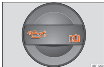
Fig. 179 Capacul bușonului orificiului de umplere cu ulei din compartimentul motor.
