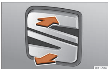
Fig. 55 Hayonul: deschiderea din exterior.
