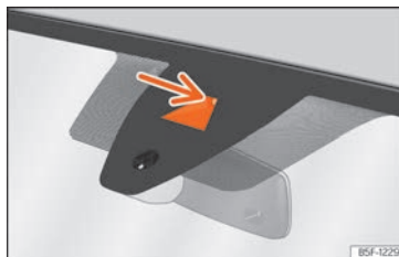
Fig. 96 Pe parbriz: câmpul vizual al camerei sistemului Lane Assist.
