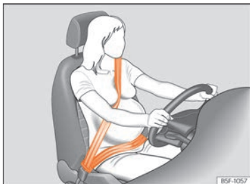
Fig. 24 Poziția centurii de siguranță în timpul sarcinii.
