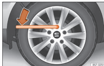
Fig. 189 Înlocuirea unei roți: slăbiți șuruburile de roată.
