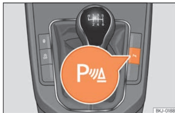
Fig. 121 Consola centrală: butonul de asistență la parcare (în funcție de versiune).
