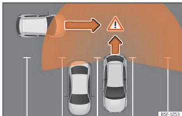
Fig. 124 Diagrama asistentului la parcare: zona detectată din jurul autovehiculului care ieșea din parcare.
