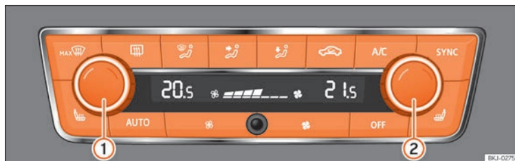
Fig. 80 În consola centrală: panoul de comandă al sistemului Climatronic.
