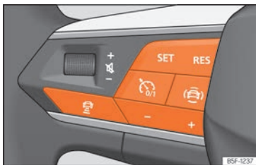
Fig. 104 Pe volanul multifuncțional: butoanele pentru operarea ACC.
