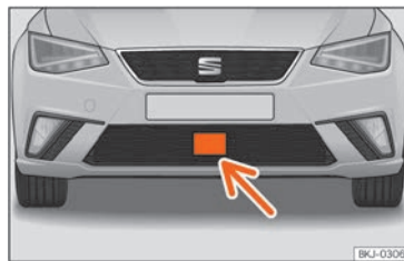
Fig. 94 Pe bara de protecție față: senzorul radar.
