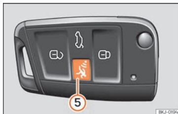
Fig. 44 Cheia cu telecomandă, cu buton de alarmă.
