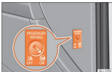
Fig. 27 Comutatorul pentru activarea și dezactivarea airbagului pasagerului față.
