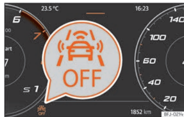
Fig. 112 Pe ecranul panoului de instrumente: Mesajul Front Assist dezactivat.
