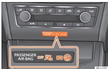
Fig. 28 Partea centrală a panoului de instrumente: lampa de control pentru airbag frontal pasager dezactivat, de pe consola centrală.
