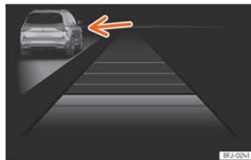
Fig. 105 Pe ecranul panoului de bord: ACC activ, autovehicul detectat în stânga.
