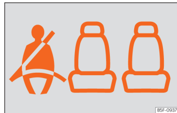
Fig. 18 Panoul de bord: indicație cu privire la starea centurilor de siguranță spate.
