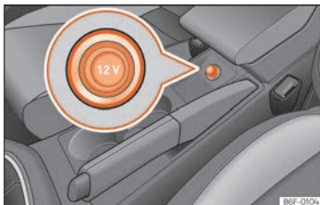
Fig. 128 Priza electrică de 12 V a autovehiculului.
