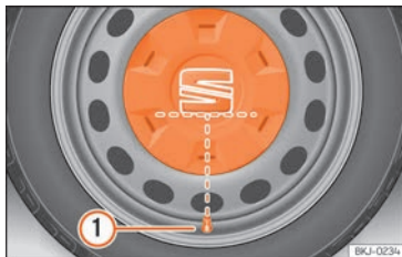
Fig. 185 Poziția corectă a ornamentului central al jantelor din oțel.
