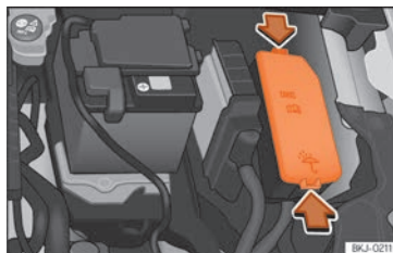
Fig. 161 În compartimentul motor: capacul cutiei de siguranțe.
