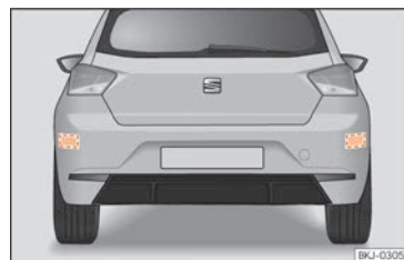
Fig. 97 Autovehiculul văzut din spate: suprafețele cu senzori radar.
