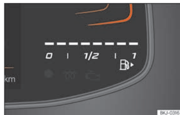
Fig. 3 Panoul de bord de bază: indicator rezervă combustibil.
