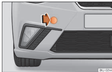
Fig. 156 Partea dreaptă a barei de protecție față: demontați capacul.
