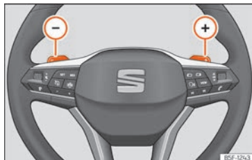
Fig. 89 Volanul: manete pentru cutia de viteze automată
