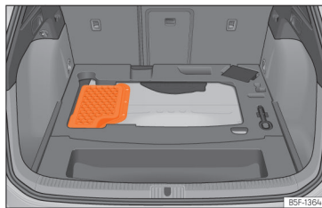
Fig. 235 Autovehicule hibride (PHEV): amplasarea bateriei în portbagaj
