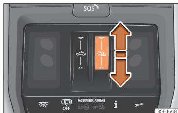
Fig. 89 Pe plafon: acționarea ruloului parasolar.
