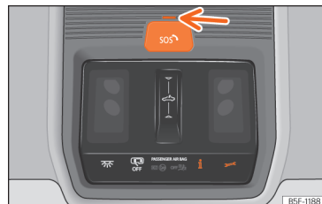
Fig. 49 Pe consola din plafon: comenzi pentru serviciile vocale.
