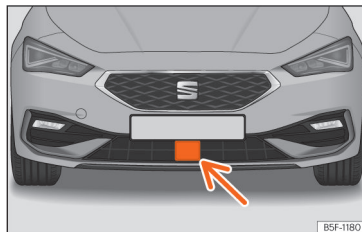
Fig. 127 Pe bara de protecție față: senzorul radar.
