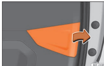
Fig. 173 Hayonul deschis: scoateți capacul.
