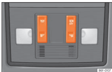
Fig. 71 Detaliu plafon: luminile interioare din față.
