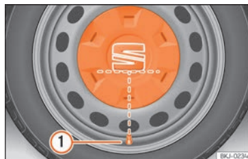
Fig. 193 Poziția corectă a ornamentului central al jantelor din oțel.
