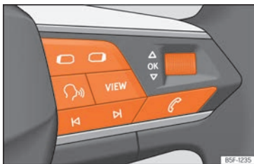
Fig. 10 Partea dreaptă a volanului multifuncțional: butoanele de accesare a meniurilor și informațiilor de pe panoul de instrumente (în funcție de versiune).
