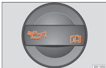
Fig. 187 Capacul bușonului orificiului de umplere cu ulei din compartimentul motor.
