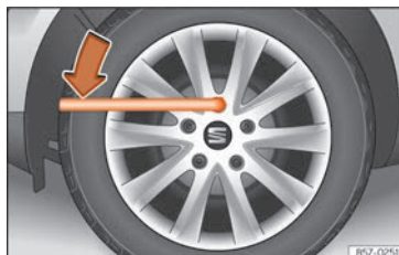
Fig. 196 Înlocuirea unei roți: slăbiți șuruburile de roată.
