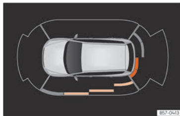
Fig. 121 Modul de vizualizare al sistemului de asistență la parcare pe ecranul sistemului Infotainment.
