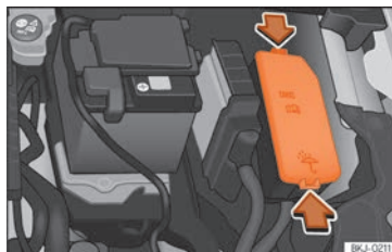
Fig. 169 În compartimentul motor: capacul cutiei de siguranțe.
