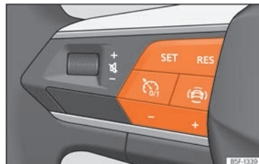
Fig. 99 Pe volanul multifuncțional: butoanele pentru controlul limitatorului de viteză.
