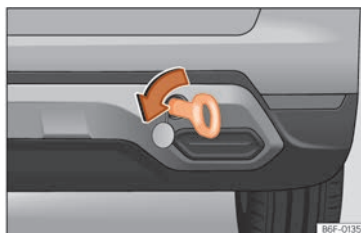
Fig. 167 Partea dreaptă a barei de protecție spate: inel de remorcare înșurubat.
