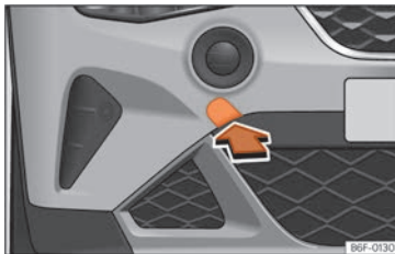
Fig. 164 Partea dreaptă a barei de protecție față: demontați capacul.
