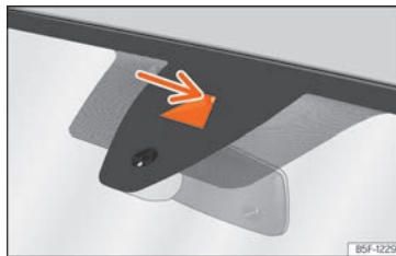
Fig. 94 Pe parbriz: câmpul vizual al camerei sistemului Lane Assist.
