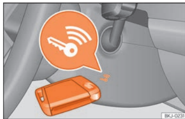
Fig. 82 Pe partea dreaptă a coloanei de direcție: pornirea de urgență.
