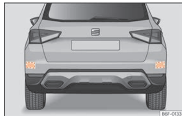
Fig. 95 Autovehiculul văzut din spate: suprafețele cu senzori radar.
