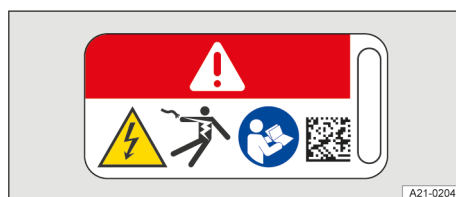
Fig. 5 Plăcuță de avertizare pe componentele de înaltă tensiune.
