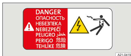
Fig. 4 Plăcuță de avertizare pe componentele de înaltă tensiune.
