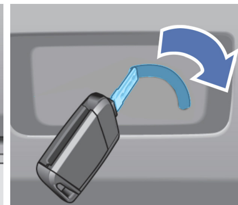
Introduceți cheia în fantă și glisați-o pentru a debloca
