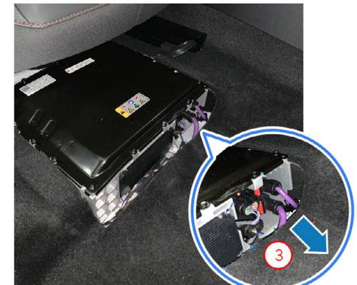
Deconectarea instalației electrice de 48 V a autovehiculului în autovehicule mild hybrid (MHEV).
