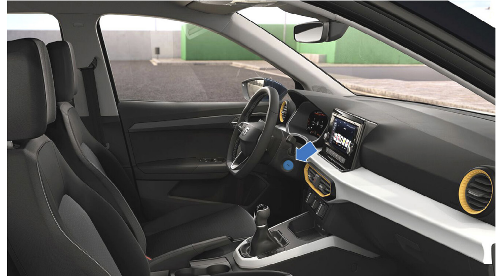
Autovehicul cu cheie de contact pe coloana de direcție.
