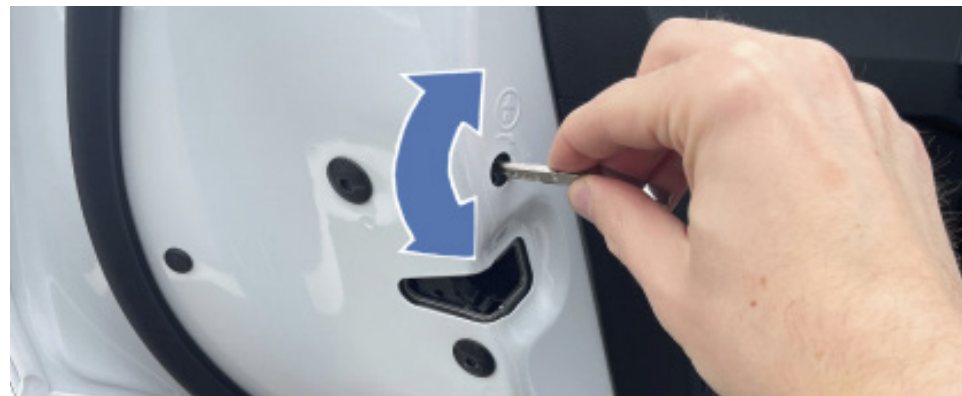
Dezactivați mecanic siguranța pentru copii, folosind cheia.
