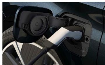
Capacul prizei de încărcare la modelul LEON eHybrid (hibrid plug-in)
