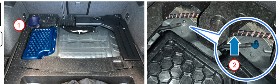
Exemplu de deconectare a sistemului de 12 V la un model Leon PHEV.
