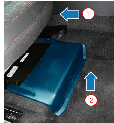
Deconectarea instalației electrice de 48 V a autovehiculului în autovehicule mild hybrid (MHEV).
